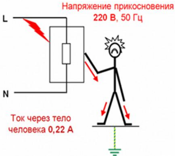
Корпус без заземления
