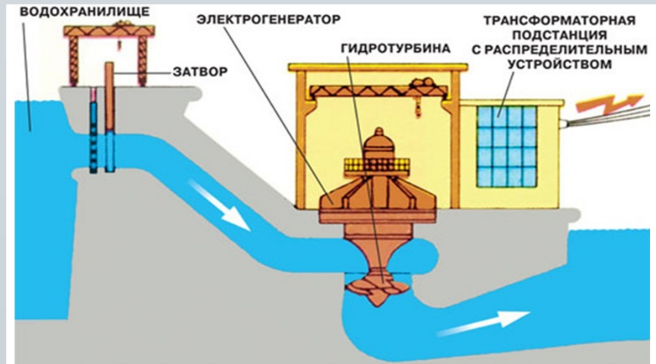
Принцип работы гидроэлектростанции
